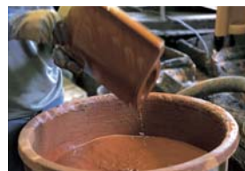
▲吉富赤瓦の釉薬をかける作業の様子。
